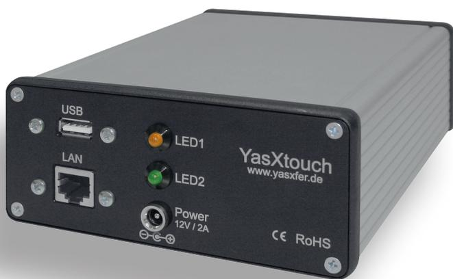
YasXTouch ermöglicht die automatisierte Ansicht von Fehlerdiagnosen, Anlagendatenerfassung und Backups per Fernzugriff auf bis zu 15 Steuerungen. Durch zusätzliches Anschließen eines Barcode-Scanners können die zu produzierenden Artikel schnell und einfach ausgewählt bzw. geändert werden.
