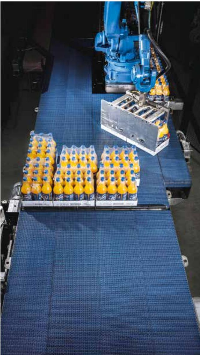
Das Sortiertisch-Förderband kann entweder für einzelne Flaschen oder für Flaschen in Multipacks verwendet werden.
