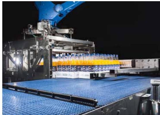
Der automatische Schieber für Multipacks ist fester Bestandteil im Steuerungssystem des MOTOMAN-Roboters.
