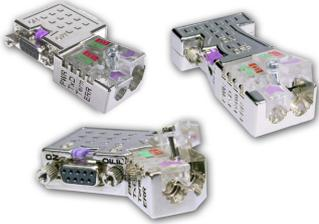
In PROFIBUS werden alle Teilnehmer parallel verdrahtet. Hierzu ist das Buskabel durchzuschleifen. Unter der Best.-Nr. 972-0DP10 erhalten Sie von Yaskawa den Stecker "EasyConn". Dies ist ein Busanschluss-Stecker mit zuschaltbarem Abschlusswiderstand und integrierter Busdiagnose.
