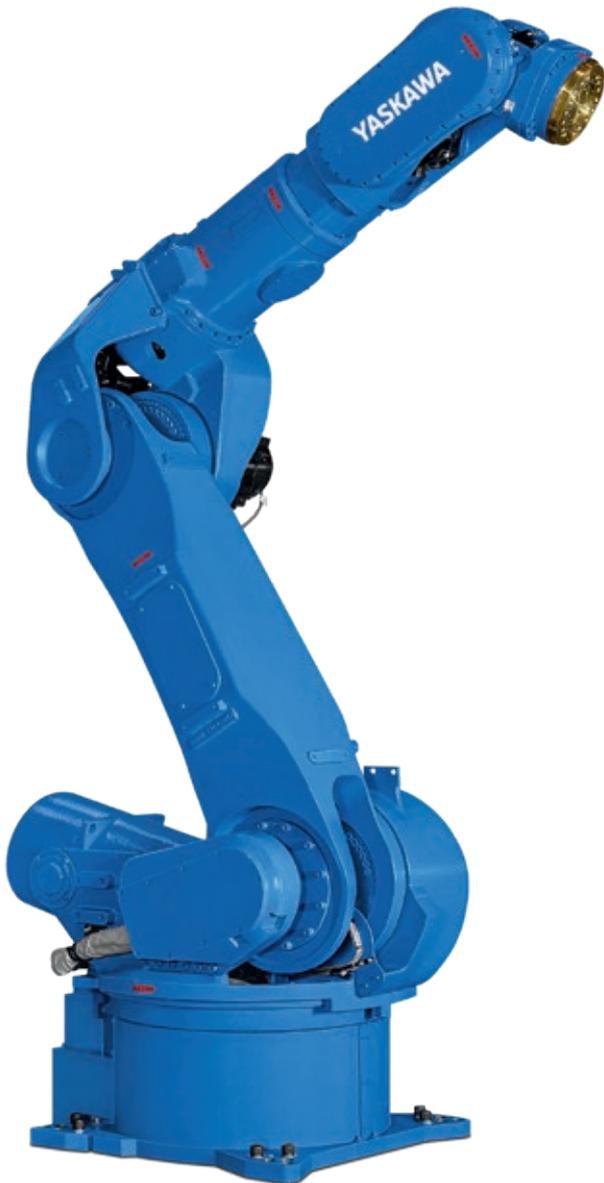
Der MOTOMAN GG250 ist ein 6-achsiger Schweißroboter speziell für das Rührreischweißen, welcher sich durch seine außerordentliche Steifigkeit auszeichnet. Dieser Industrieroboter mit einer Traglast von 250 kg und einem Arbeitsbereich von bis zu 2711 mm wurde speziell für den Einsatz vom schweren und ausladenden Schweißequipment für das Rührreischweißen – auch bekannt als Friction Stir Welding (FSW) – entwickelt.
