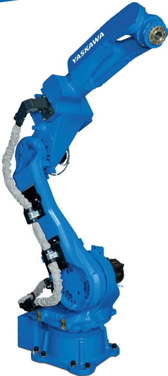
Der MOTOMAN GP35H ist ein Hochgeschwindigkeitsroboter mit hohlem Handgelenk, der eine größere Reichweite für große Werkstücke bietet. Strom- und Zusatzkabel verlaufen im Inneren des Handgelenks, was die Beweglichkeit des Roboters verbessert und gleichzeitig das Risiko von Beschädigungen minimiert, da keine Störkonturen durch externe Kabelpakete entstehen.
