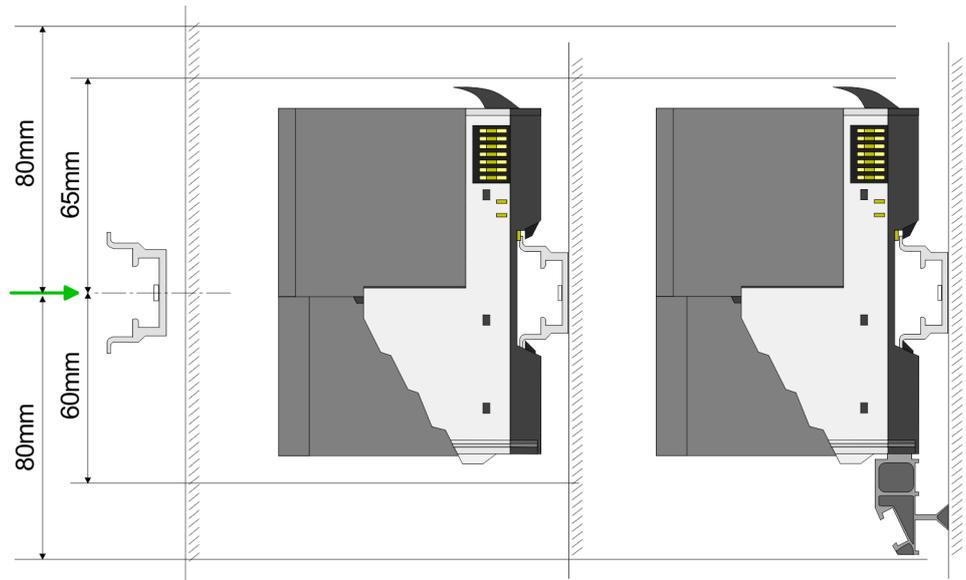
2. → Das Zeilenanschlaltung-SubDevice besitzt Verriegelungshebel an der Oberseite. Zur Montage und Demontage sind diese Hebel nach oben zu klappen, bis diese einrasten. Klappen Sie die Verriegelungshebel nach oben, stecken Sie das Zeilenanschlaltung-SubDevice auf die Tragschiene und klappen Sie die Verriegelungshebel wieder nach unten.
