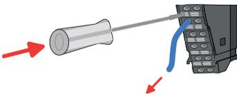
Das Entfernen eines Drahtes erfolgt mittels eines Schraubendrehers mit 2,5mm Klingebreite.
