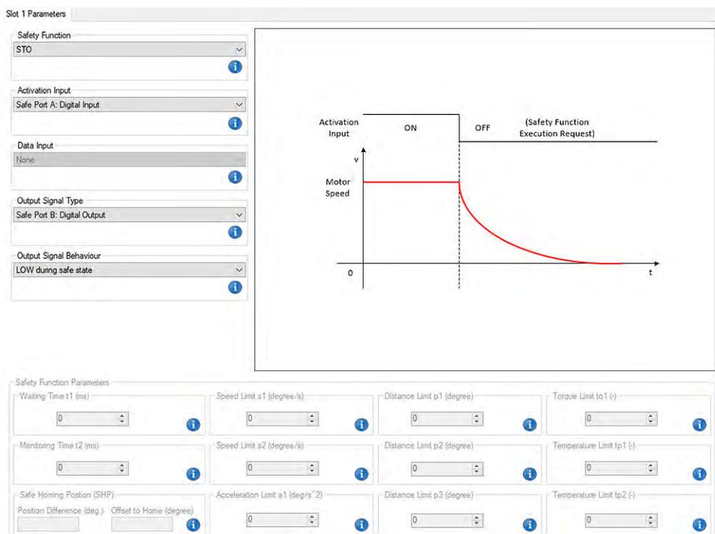
Fig. 50: Slot 1 Parameters
