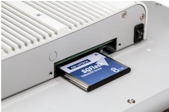
2. → Führen Sie die CFast-Karte mit der Beschriftung nach oben komplett in den Karten-Slot ein und befestigen Sie das Abdeckblech wieder.
