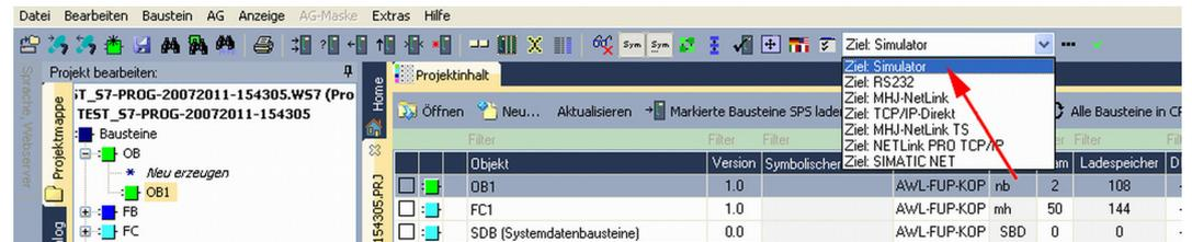
2. ➤ Übertragen Sie die Bausteine in den Simulator mit *[Alle Bausteine in CPU laden]*.
