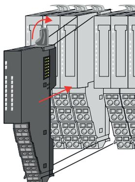
6. ➤ Stecken Sie das zu montierende Modul in die Lücke zwischen die beiden Module und schieben Sie das Modul, geführt durch die Führungsleisten auf beiden Seiten, auf die Tragschiene.
