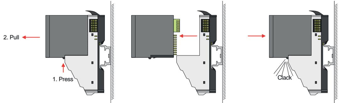
2. ➤ Zum Austausch eines Power Elektronik-Moduls können Sie das Elektronik-Modul, nach Betätigung der Entriegelung an der Unterseite, nach vorne abziehen.
