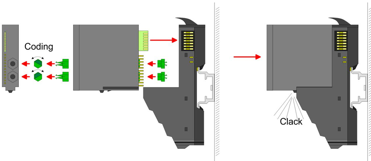
Jedes Elektronik-Modul besitzt an der Rückseite 2 Kodier-Aufnehmer für Kodier-Buchsen. Durch ihre Ausprägung sind 6 unterschiedliche Positionen pro Kodier-Buchse steckbar. Somit haben sie bei Verwendung beider Kodier-Aufnehmer 36 Kombinationsmöglichkeiten für die Kodierung.
