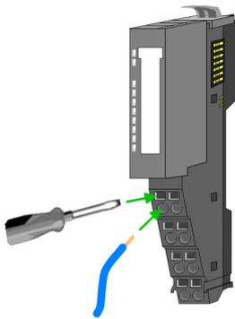
1. Zum Verdrahten stecken Sie, wie in der Abbildung gezeigt, einen passenden Schraubendreher leicht schräg in die rechteckige Öffnung. Zum Öffnen der Kontaktfeder müssen Sie den Schraubendreher in die entgegengesetzte Richtung drücken und halten.
