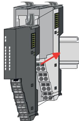
4. ➤ Klappen Sie zur Montage den Verriegelungshebel des Peripherie-Moduls nach oben, bis dieser einrastet.
