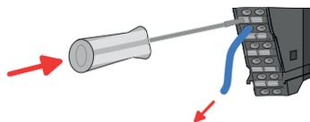
Das Entfernen eines Drahtes erfolgt mittels eines Schraubendrehers mit 2,5mm Klingenbreite.
