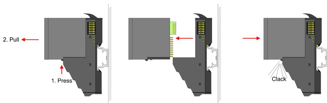
2. ➤ Zum Austausch eines Elektronik-Moduls können Sie das Elektronik-Modul, nach Betätigung der Entriegelung an der Unterseite, nach vorne abziehen.
