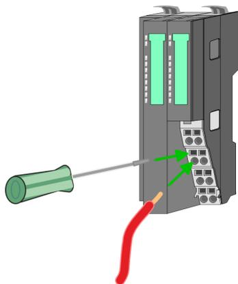
1. Zum Verdrahten stecken Sie, wie in der Abbildung gezeigt, einen passenden Schraubendreher leicht schräg in die rechteckige Entriegelung. Zum Öffnen der Kontaktfeder müssen Sie den Schraubendreher in die entgegengesetzte Richtung drücken und halten.
