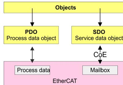
**PDO** steht für **Process Data Object**. Mittels PDOs können Sie zur Laufzeit Prozessdaten übertragen. Hierbei adressieren Sie im Telegramm direkt die entsprechenden Ein- bzw. Ausgänge. Näheres zur Prozessdatenübertragung zur Laufzeit finden Sie in der Beschreibung zu Ihrem EtherCAT-Master.
