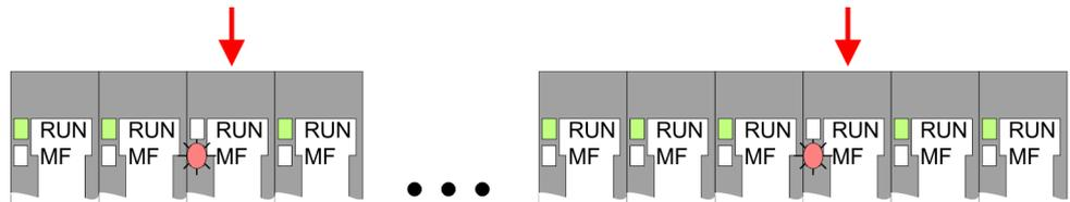
*Verhalten:* Nach dem Einschalten blinkt an einem Modul bzw. an mehreren Modulen die MF-LED. Die RUN-LED bleibt ausgeschaltet.
