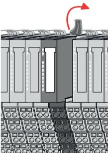
4. Klappen Sie den Verriegelungshebel des zu tauschenden Moduls nach oben.
