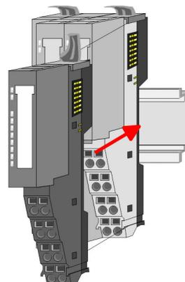
4. ➔ Klappen Sie zur Montage den Verriegelungshebel des Peripherie-Moduls nach oben, bis dieser einrastet.
