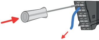
Das Entfernen eines Drahtes erfolgt mittels eines Schraubendrehers mit 2,5mm Klingbreite.
