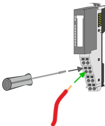
1. Zum Verdrahten stecken Sie, wie in der Abbildung gezeigt, einen passenden Schraubendreher leicht schräg in die rechteckige Öffnung. Zum Öffnen der Kontaktfeder müssen Sie den Schraubendreher in die entgegengesetzte Richtung drücken und halten.
