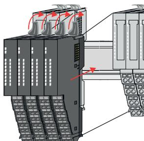
6. → Stecken Sie die zu montierende Modulgruppe in die Lücke zwischen die beiden Module und schieben Sie die Modulgruppe, geführt durch die Führungsleisten auf beiden Seiten, auf die Tragschiene.
