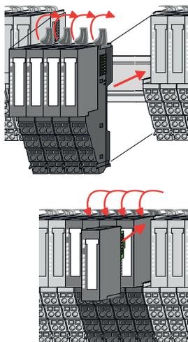
7. ➔ Stecken Sie die zu montierende Modulgruppe in die Lücke zwischen die beiden Module und schieben Sie die Modulgruppe, geführt durch die Führungsleisten auf beiden Seiten, auf die Tragschiene.
