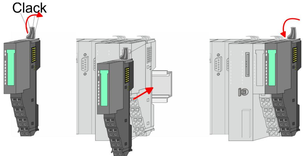
2. Montieren Sie die gewünschten Peripherie-Module.
