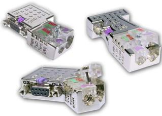
In PROFIBUS werden alle Teilnehmer parallel verdrahtet. Hierzu ist das Buskabel durchzuschleifen. Unter der Best.-Nr. 972-ODP10 erhalten Sie von VIPA den Stecker "EasyConn". Dies ist ein Busanschlussstecker mit zuschaltbarem Abschlusswiderstand und integrierter Busdiagnose.
