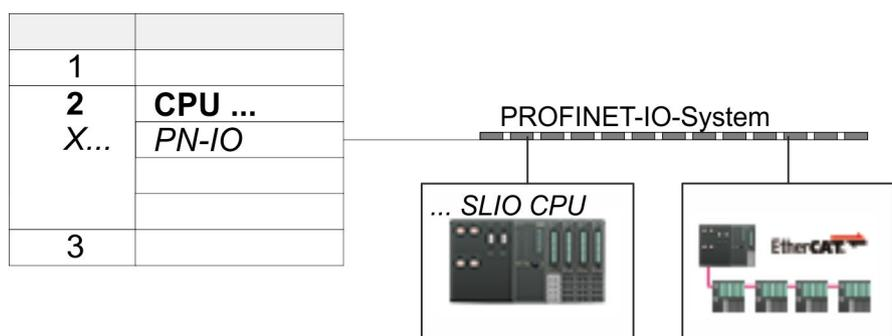
1. Navigieren Sie im Hardware-Katalog in das Verzeichnis *"PROFINET IO → Weitere Feldgeräte → I/O → VIPA EtherCAT System"* und binden Sie das IO Device *"SLIO EtherCAT System"* an Ihr PROFINET-System an.
