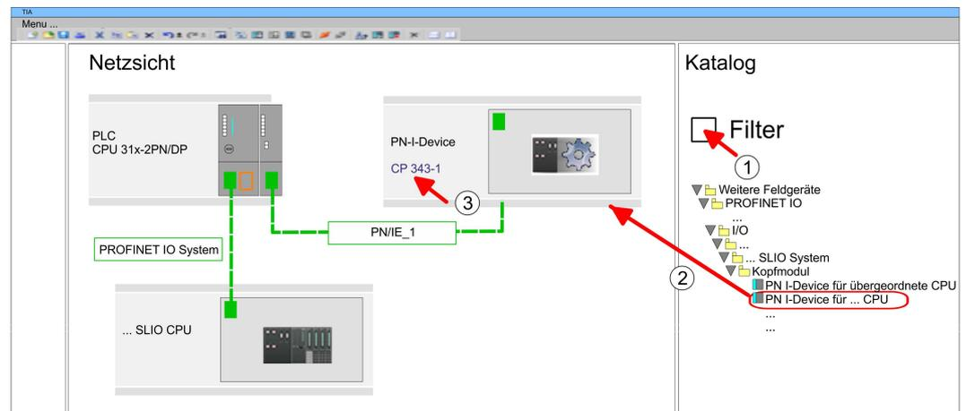
5. ➤ Klicken Sie in der *Netzsicht* auf das PN I-Device und wechseln Sie in die *Geräteübersicht*.
