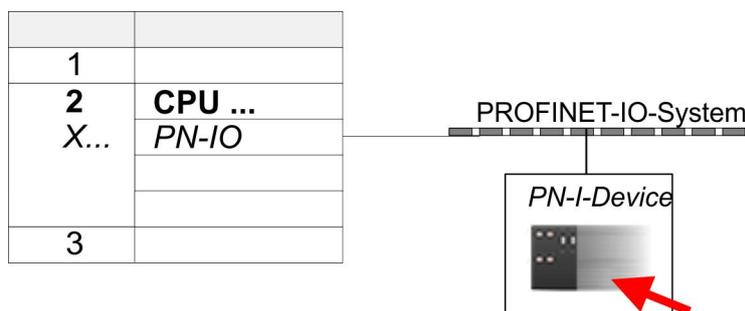
4. Legen Sie für jeden Ausgangsbereich des I-Device im IO-Controller einen Eingangsbereich gleicher Größe an und umgekehrt. Auch hierbei dürfen sich keine Lücken in der Steckplatzbelegung ergeben. Achten Sie insbesondere darauf, dass die Reihenfolge der Transferbereiche zu denen der I-Device-Projektierung passt. Die folgenden Transferbereiche stehen zur Verfügung:
