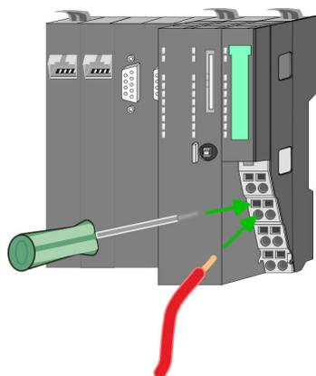
1. Zum Verdrahten stecken Sie, wie in der Abbildung gezeigt, einen passenden Schraubendreher leicht schräg in die rechteckige Entriegelung. Zum Öffnen der Kontaktfeder müssen Sie den Schraubendreher in die entgegengesetzte Richtung drücken und halten.
