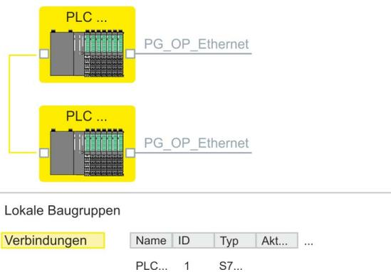
5. ➤ Projektieren Sie auf diese Weise weitere Verbindungen. Sie können auch über die *Verbindungstabelle* Ihre Verbindungen bearbeiten, indem Sie eine Verbindung anwählen und über das Kontextmenü die entsprechende Funktion wie *"Neue Verbindung einfügen"* ausführen.
