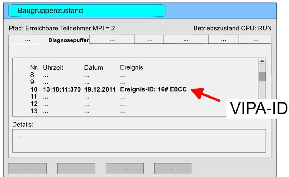
Für die Diagnose ist der Betriebszustand der CPU irrelevant. Es können maximal 100 Diagnoseeinträge in der CPU gespeichert werden. ↪ *Anhang A "Systemspezifische Ereignis-IDs" Seite 316*
