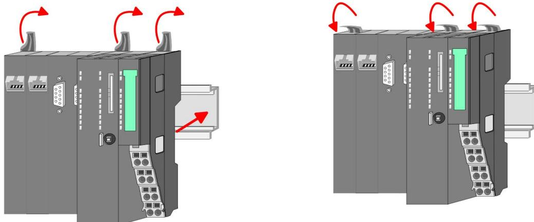
2. Klappen Sie die Verriegelungshebel der CPU nach oben, stecken Sie die CPU auf die Tragschiene und klappen Sie die Verriegelungshebel wieder nach unten.
