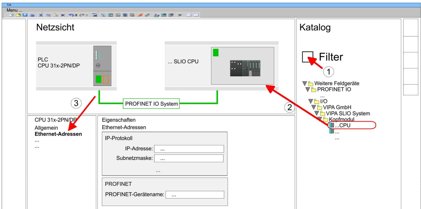
5. ➔ Wählen Sie in der *Netzschritt* das IO-Device "VIPA SLIO CPU..." an und wechseln Sie in die *Geräteübersicht*.
