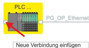
2. ➔ Öffnen Sie mit "Kontextmenü ➔ Neue Verbindung einfügen" den Dialog zum Anlegen einer Verbindung
