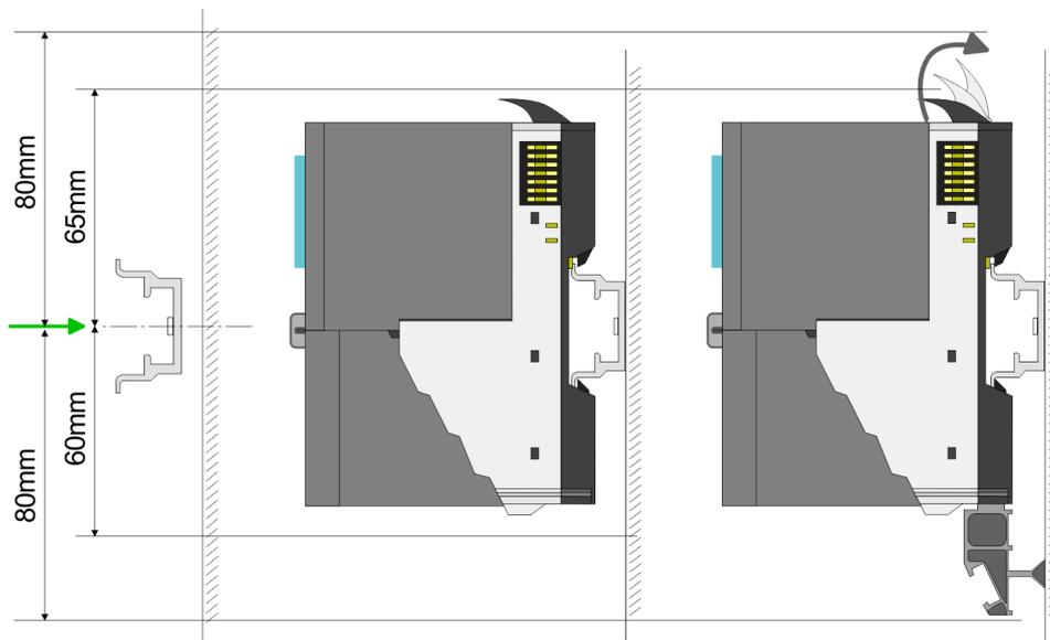
1. Montieren Sie die Tragschiene! Bitte beachten Sie, dass Sie von der Mitte der Tragschiene nach oben einen Montageabstand von mindestens 80mm und nach unten von 60mm bzw. 80mm bei Verwendung von Schirmschienen-Trägern einhalten.
