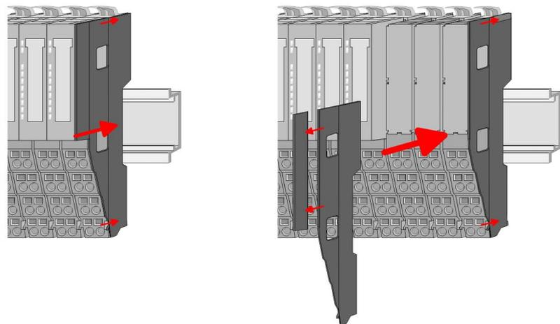
3. Nachdem Sie Ihr Gesamt-System montiert haben, müssen Sie zum Schutz der Bus-Kontakte die Bus-Blende am äußersten Modul wieder stecken. Handelt es sich bei dem äußersten Modul um ein Klemmen-Modul, so ist zur Adaption der obere Teil der Bus-Blende abzubrechen.
