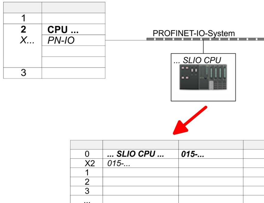
11. Navigieren Sie im Hardware-Katalog in das Verzeichnis *"PROFINET IO → Weitere Feldgeräte → I/O → VIPA SLIO System"* und binden Sie das IO-Device *"015-CEFNR00 CPU"* an Ihr PROFINET-System an.
