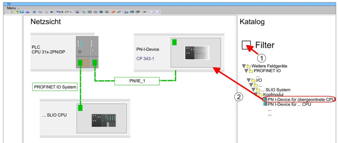
3. ➔ Klicken Sie in der *"Netzansicht"* auf das *"PN-I-Device"* und tragen Sie unter *"Gerätename"* den zuvor notierten Namen des VIPA I-Device ein.
