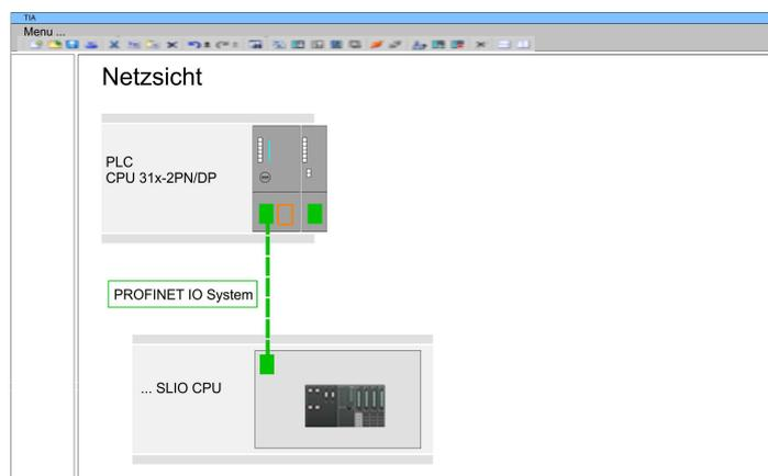
2. ➔ Zur Projektierung des VIPA I-Devices im übergeordneten IO-Controller entnehmen Sie aus dem Hardware-Katalog unter *PROFINET-IO* das Gerät *"PN I-Device für übergeordnete CPU"*, ziehen Sie dieses in die *Netzansicht* und binden Sie dieses über PROFINET an die CPU an.
