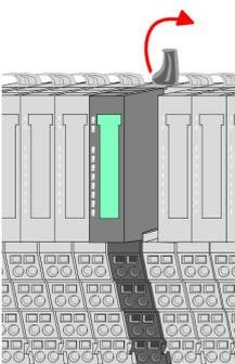
4. ➤ Klappen Sie den Verriegelungshebel des zu tauschenden Moduls nach oben.
