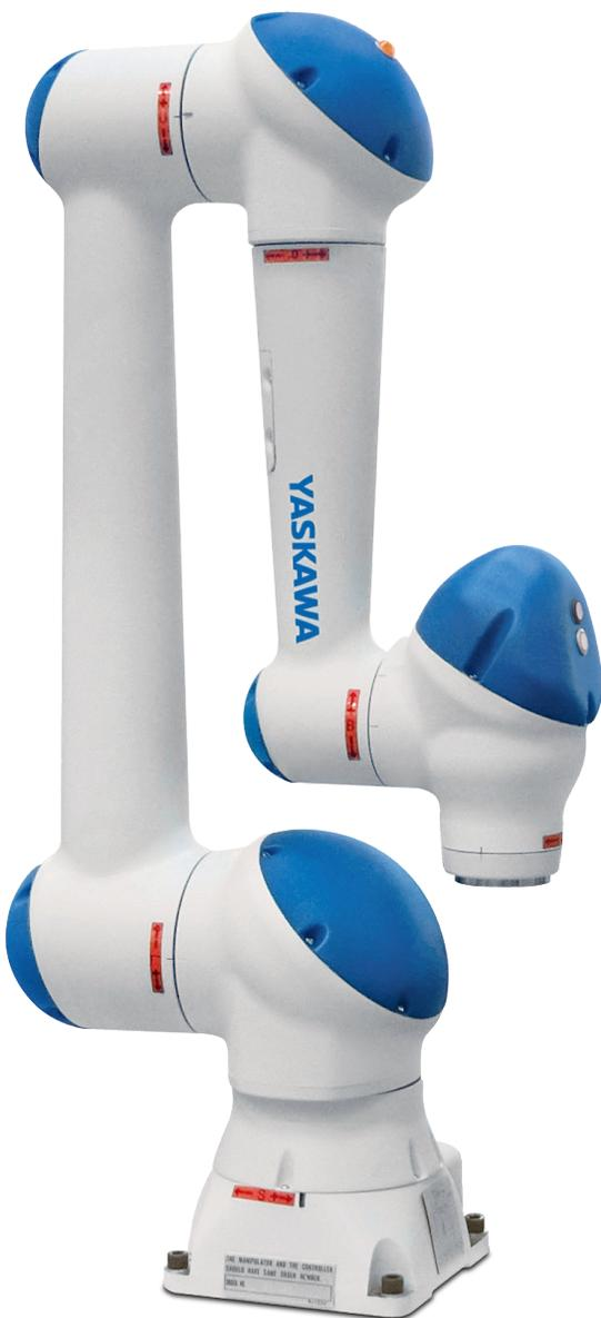
El robot MOTOMAN HC10 es un robot colaborativo de 6 ejes con una carga útil de 10 kg. Dispone de un eficiente sensor de fuerza que detiene al robot en caso de contacto con un operador.
